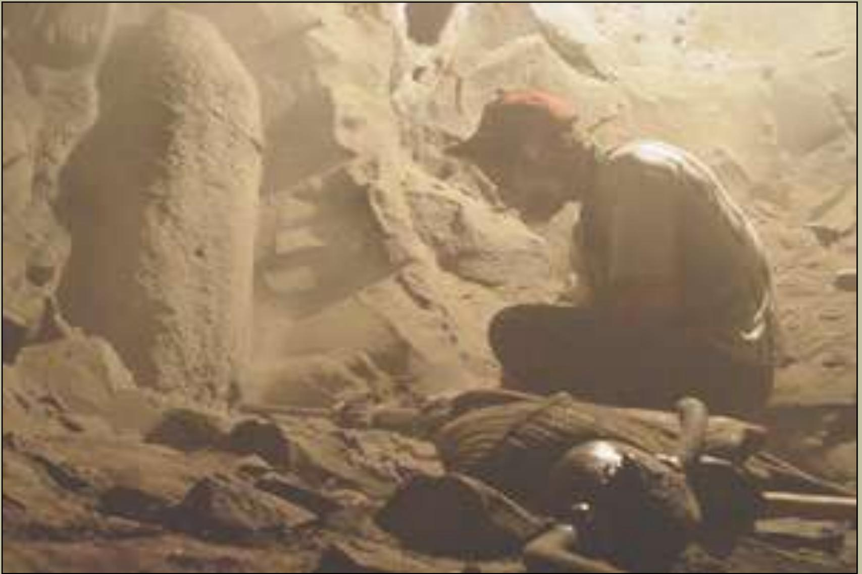
Processo de extração dos geodos do basalto inalterado em galerias
